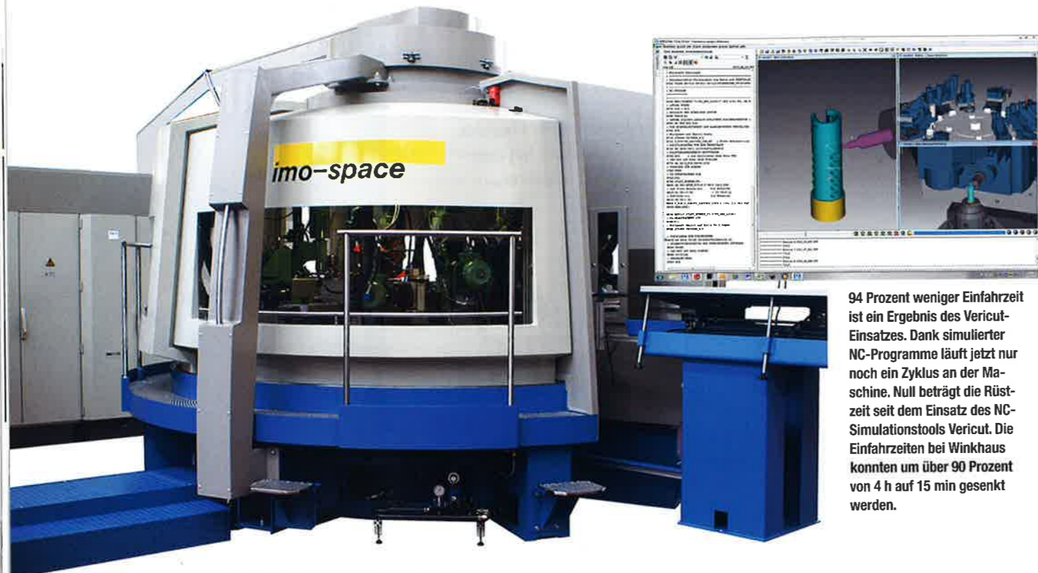
Die Rundtaktmaschine Imo-Space des Schweizer Herstellers Imoberdorf AG wird mit Vericut simuliert. Die Maschine mit bis zu 16 Bearbeitungsstationen nutzt Winkhaus zur Serienfertigung bei Losgrößen von 10 bis 100 000 Teilen.
