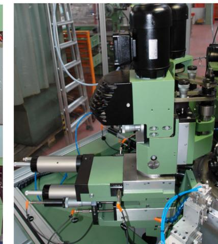
Beide Bearbeitungseinheiten sind mit stufenlosen Vorschub-Zylindern bestückt. Diese arbeiten gegen mechanische Anschläge die mittels Mikrometerschrauben eingestellt werden können.
