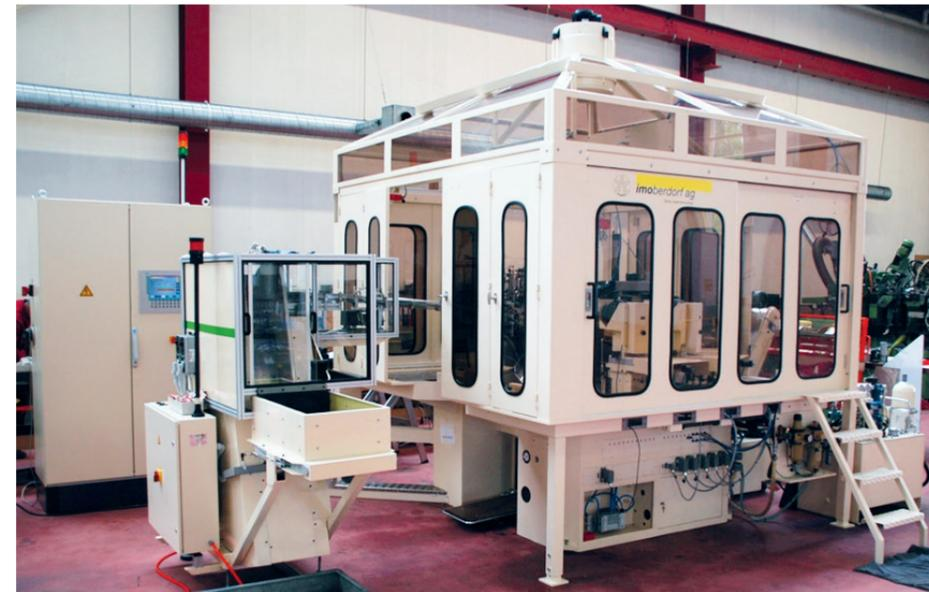
**I-76 mit 12 Stationen** nach einer kompletten Revision. Ausgestattet mit einer neuen SPS Steuerung. Nach 30 Jahren immer noch so präzise wie eine neue Maschine. Sprichwörtliche Imoberdorf Swiss made Qualität.
