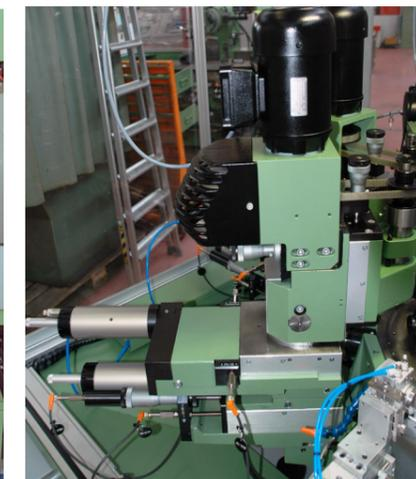
Les deux unités de traitement sont équipées de cylindres d'alimentation en continu. Ceux-ci agissent contre des butées mécaniques réglables à l'aide de vis micrométriques
