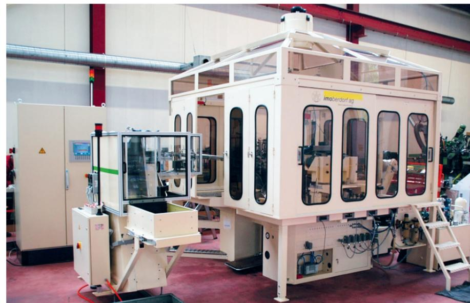
**I-76 avec 12 stations** après une révision complète. Équipé d'un nouveau contrôle PLC. Après 30 ans, toujours aussi précis qu'une nouvelle machine. Qualité proverbiale Imoberdorf fabriquée en Suisse.
